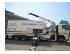
可搬型大容量海水送水ポンプ車
