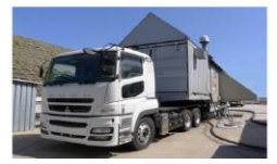
代替非常用発電機
