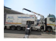
可搬型大容量海水送水ポンプ車
