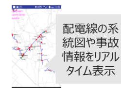
配電線事故復旧支援携帯アプリ
