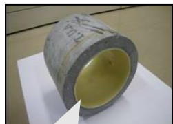
管路の内部をエポキシ樹脂等で補修
