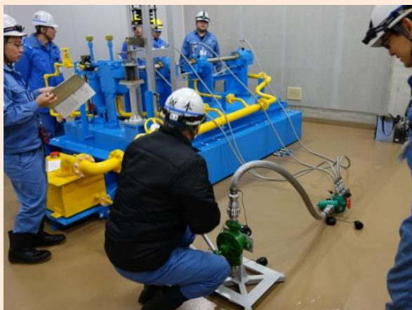
訓練装置を用いた重大事故時の訓練 (タービン動補助給水ポンプ起動訓練)
