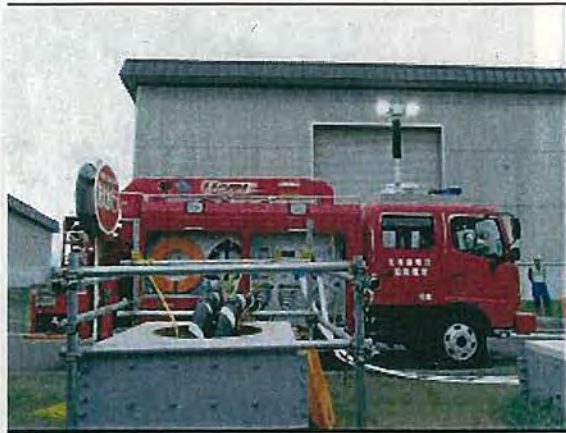
写真 3-31 防火水槽からの取水状態
