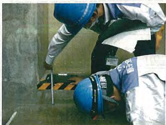
写真 2-15 T/D-AFWP 室扉の床～下端距離
