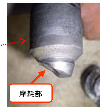
不具合状況 (弁内部部品摩耗)
