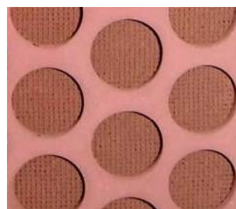
清掃前 (金網が目詰まりしている)
