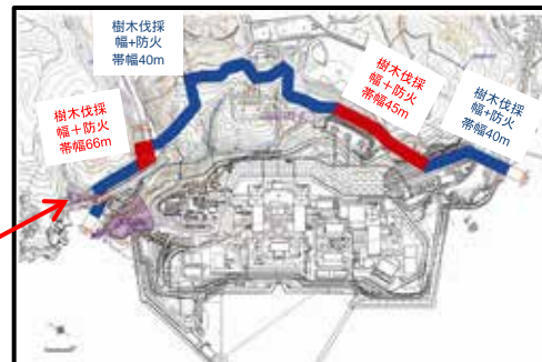
泊発電所防火帯
