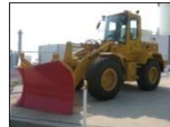
<がれき撤去用の重機>
