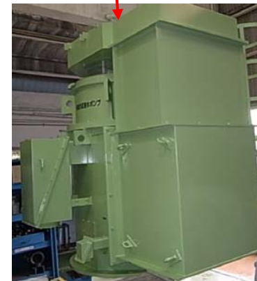
海水ポンプ電動機予備機
