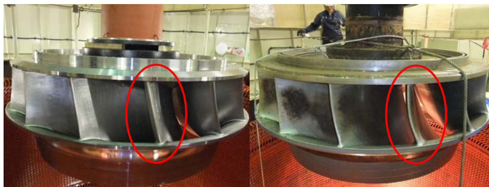
豊平峡発電所で採用された新型水車ランナ（左）と旧水車ランナ（右）
