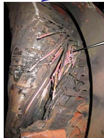
写真2. コイル損傷箇所詳細
