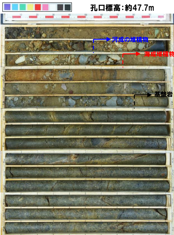
コア写真(確認-3:深度0~15m)
