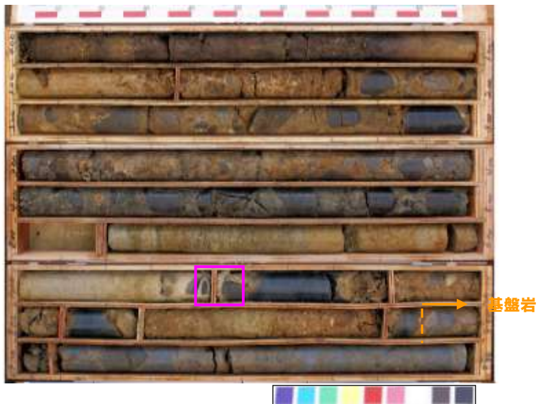
□ : 洞爺火山灰確認位置 (6.4m~6.5m) EL19.4m~19.3m コア写真(照岸1-3)
