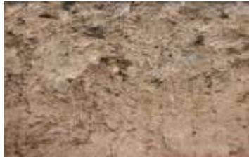
シルト層に角礫、亜角礫が混入する。
