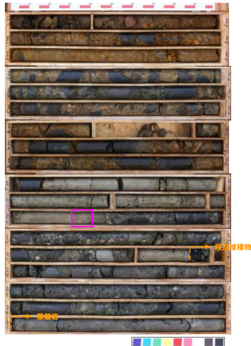
□ : 洞爺火山灰確認位置 (11.3m~11.4m) EL26.8m~26.7m コア写真(照岸1-5)
