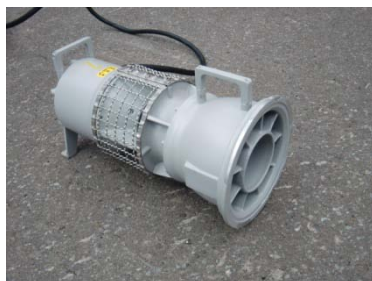
⑥送水ポンプ車に搭載している 取水ポンプ
