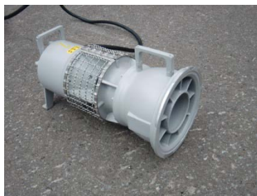
⑥送水ポンプ車に搭載している 取水ポンプ
