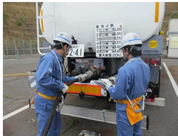
①タンクローリに給油ホースを接続
