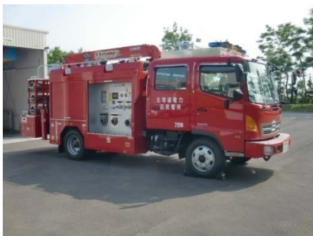
①可搬型大型送水ポンプ車のイメージ 写真は、泊1, 2号機用の中型送水ポンプ車
