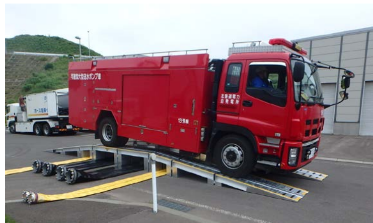
放水砲用のホース用のホースブリッジ
