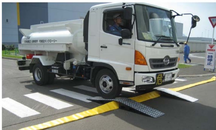
可搬型大型送水ポンプ車を用いた補給、注水対応等で敷設するホース用のホースブリッジ
