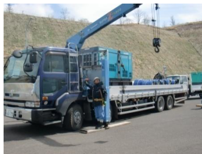
水中ポンプ及び駆動用 発電機搭載車両
