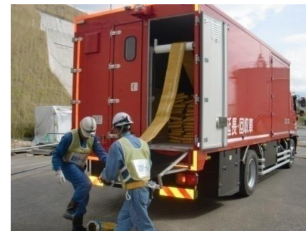
ホース延長・回収車からの手動によるホースの引出作業
